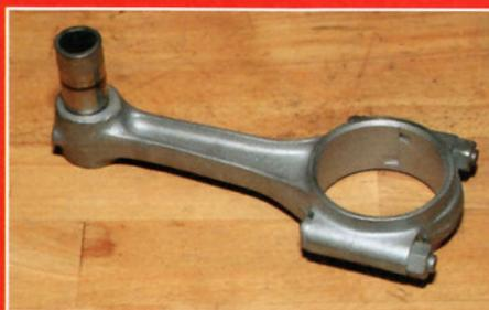
Die matte Oberfläche nach dem Kugelstrahlen verleiht dem Pleuel ein edles Aussehen
