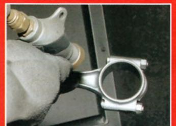
Das Kugelstrahlen verdichtet die Oberfläche und macht sie belastbarer
