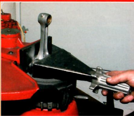
Oft ist es notwendig, dass die Trennfläche zwischen Pleuel und Lagerdeckel nachgearbeitet wird. Auch dafür gibt es eine spezielle Maschine, in der horizontal ein Schleifstein rotiert
