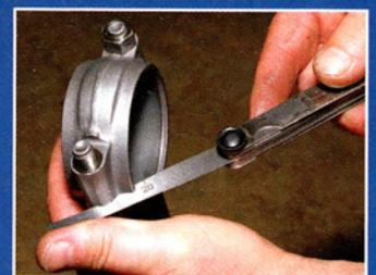
Mit einer Schraube sollte dieser Spalt zwei Zehntel Millimeter betragen
