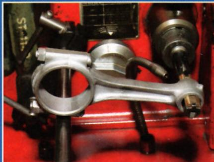
Die Honmaschine erzeugt in der neu eingesetzten Buchse das endgültige Maß
