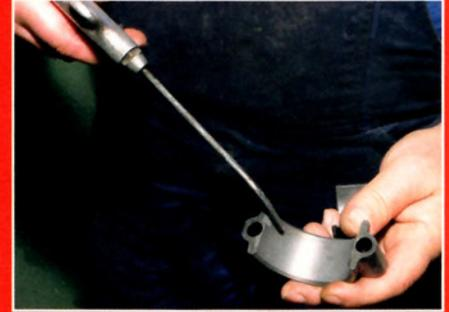
Vor dem Einsetzen der Lagerschalen werden alle Komponenten gründlich mit Pressluft gereinigt
