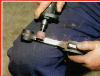
Mit einem Druckluftschleifer werden Grate entfernt und die Oberfläche...
