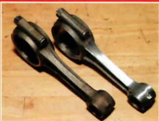
Vorher, nachher: Grate und Dellen sind entfernt, die Oberfläche ist glatt
