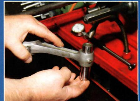
Der Bolzen sollte mit dünnflüssigem Öl durch sein Eigengewicht durch das Pleuelauge gleiten
