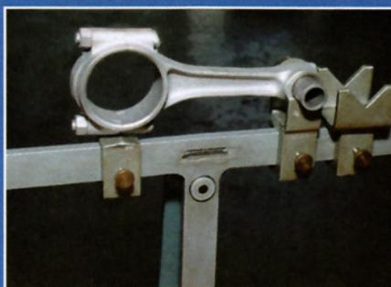
Je nach Lage des Schwerpunkts wird an geeigneten Stellen Material abgetragen
