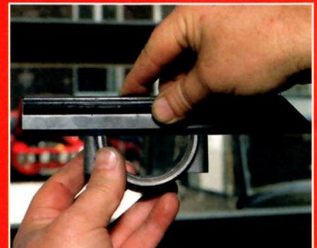
...dem Haarlineal. Die Lagerkante muss genau bündig mit der Trennfläche des Pleuelfußes sein
