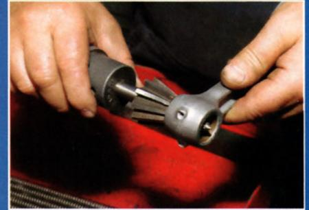
Nicht vergessen: Nur wenn die Buchse entgratet ist, stimmt später die Probe mit dem Bolzen
