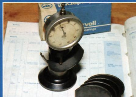
Jede einzelne Lagerschale wird vor dem Einbau nachgemessen. Fehler sind hier durchaus möglich
