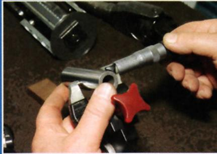
Vor dem Messen des Kolbenbolzens wird dessen Oberfläche geläppt – für ein perfektes Finish
