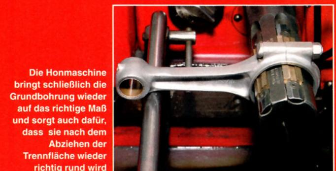
Die Honmaschine bringt schließlich die Grundbohrung wieder auf das richtige Maß und sorgt auch dafür, dass sie nach dem Abziehen der Trennfläche wieder richtig rund wird
