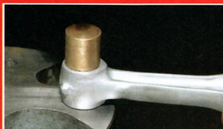
...beim Einsetzen eine Handpresse zum Einsatz – wegen des besseren Fingerspitzengefühls
