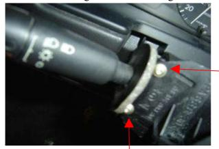
Jetz die beiden Torxschrauben entfernen und der Hebel ist lose und kann nach links herausgeschoben werden.
