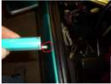
Spritze leicht spitz gefeilt damit sie in die Entlüftungslöcher passt
